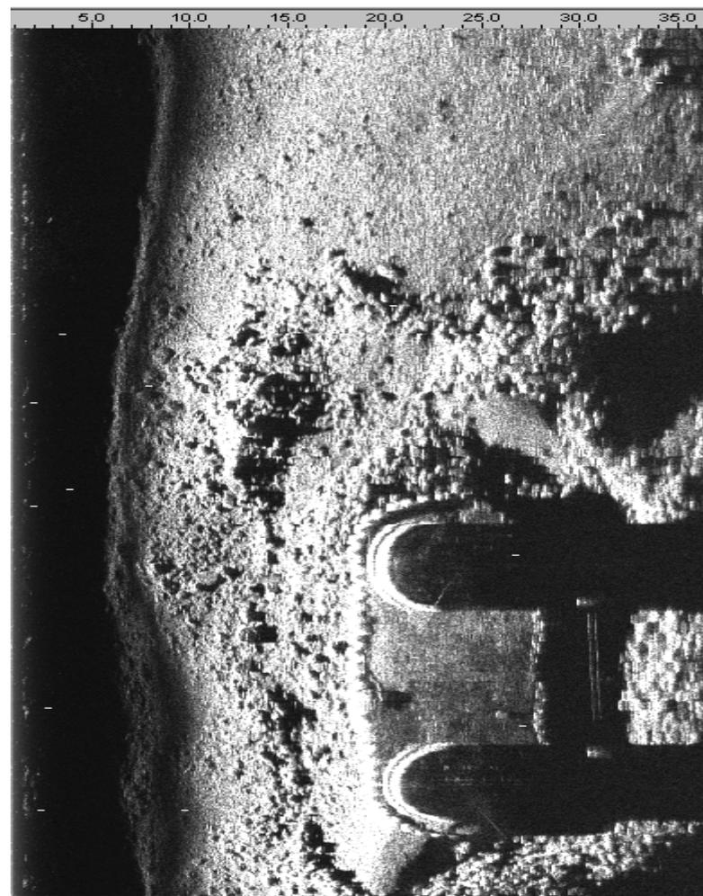
**Акустическое изображение подводной части опор моста (река Хан, Южная Корея)**
