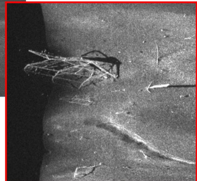
**Акустическое изображение металлических элементов конструкций на дне, глубина 5-10 м**
