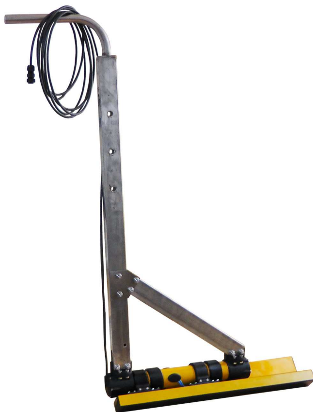
Рисунок 5. Крепление моноблока к штанге
