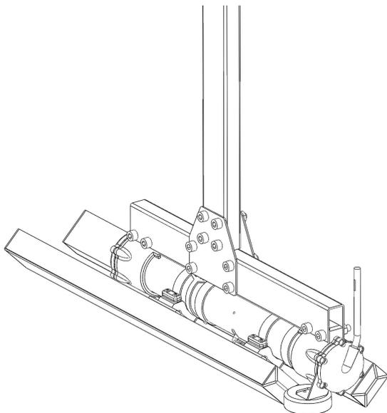
**Установка гидролокатора H5s(e)1 на штангу с помощью адаптера ИВЮТ.301529.009**
