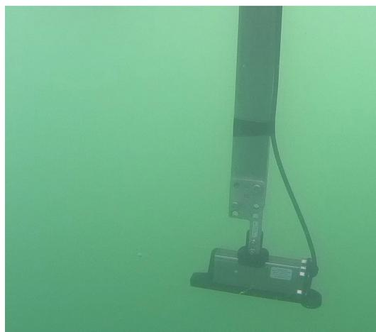
**Установка гидролокатора H5s(e)7 на штангу с помощью адаптера ИВЮТ.741134.018**
