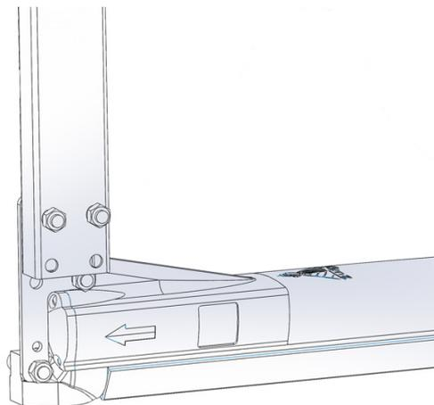
**Установка гидролокатора H5s(e)3 на штангу с помощью адаптера ИВЮТ.741134.018**
