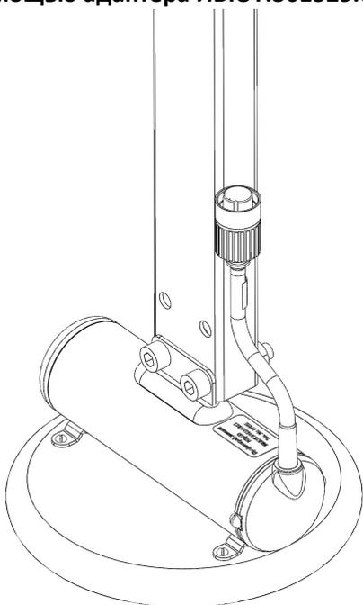
**Установка гидролокатора H5p3D на штангу**
