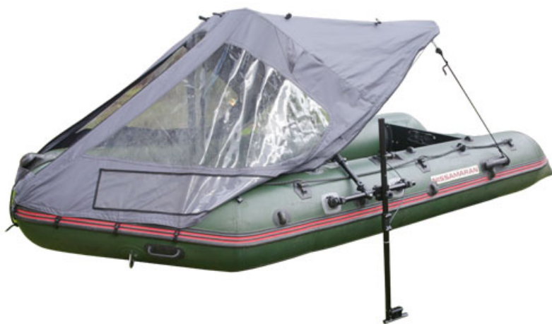
Крепление с гидролокатором H5s7E (рабочее положение)
