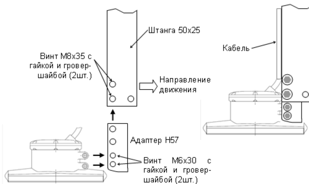
Крепление моноблока через адаптер H57 к штанге 50x25 мм
