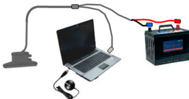
Питание моноблока от аккумулятора (компьютер работает от собственных батарей)
