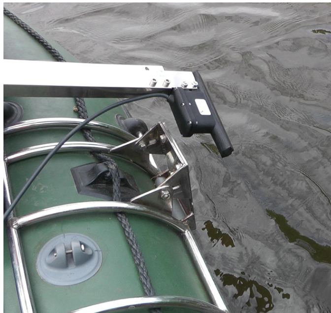
Рисунок 5. Пример крепления моноблока на штанге к борту надувной лодки с помощью установочного набора KIT001 и адаптера H57
