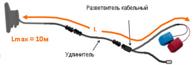
Питание моноблока от аккумулятора с винтовыми контактами
