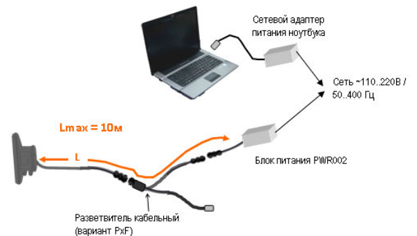
Схема электропитания моноблока и компьютера от бортсети постоянного тока =110..220В или переменного тока ~110..220В/50..400Гц
