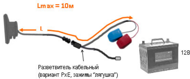
Питание моноблока от аккумулятора 12В
