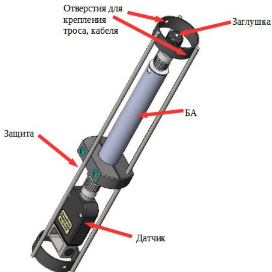
Рисунок 5. Внешний вид и размещение элементов ПСЗВ (при использовании БА, заглушки, защиты)
