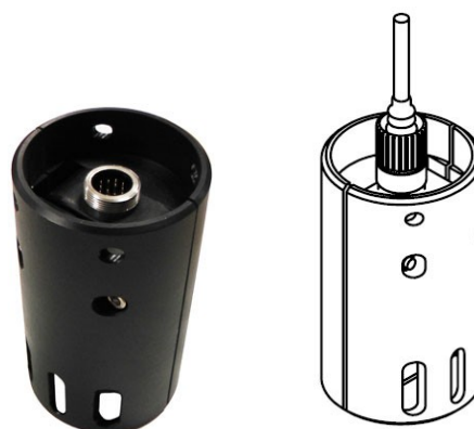
Датчик с установленной защитой
