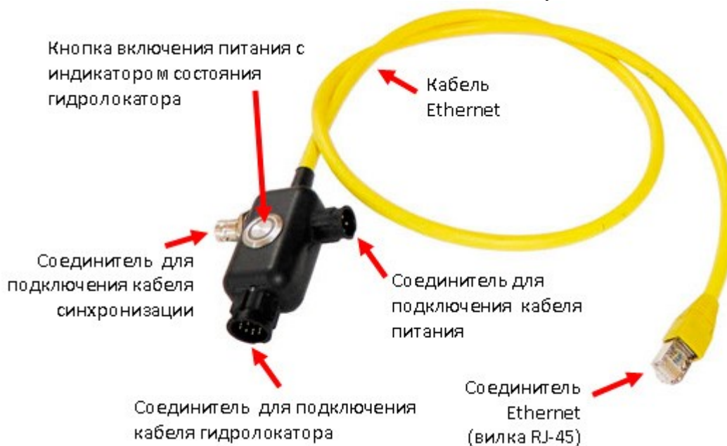
Рисунок Г.2. Разветвитель кабельный CPL002-4
