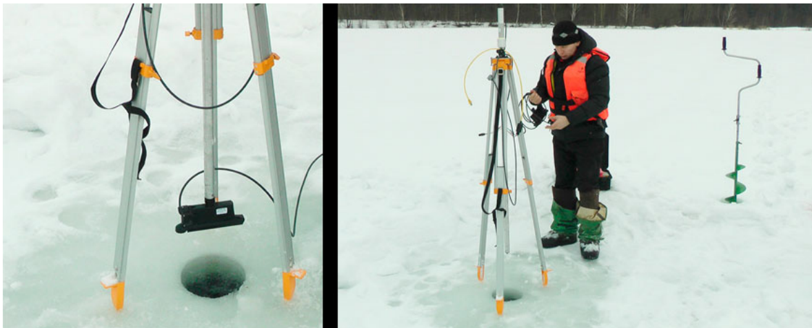
Рисунок 34. Установка ГК на SSU003 и работа со льда
