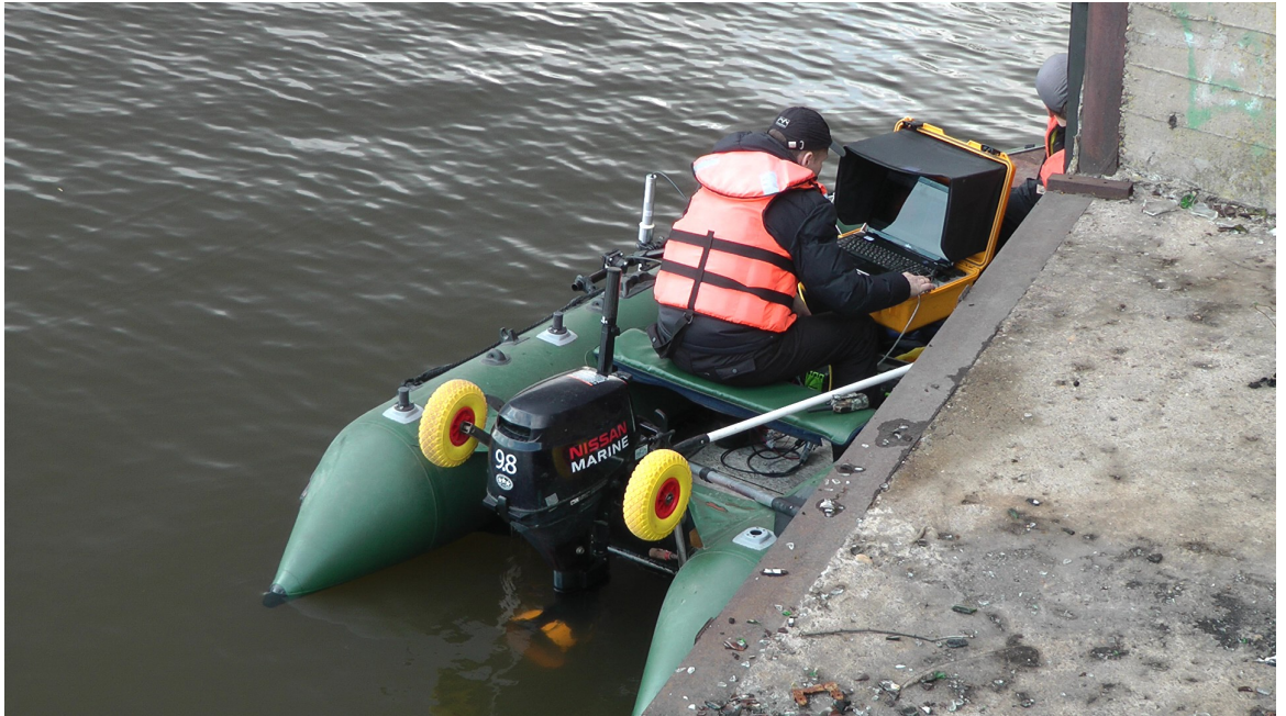
Рисунок 36. Установка ГК на SSU003 и работа с лодки (привод с ГК установлен на левый борт)
