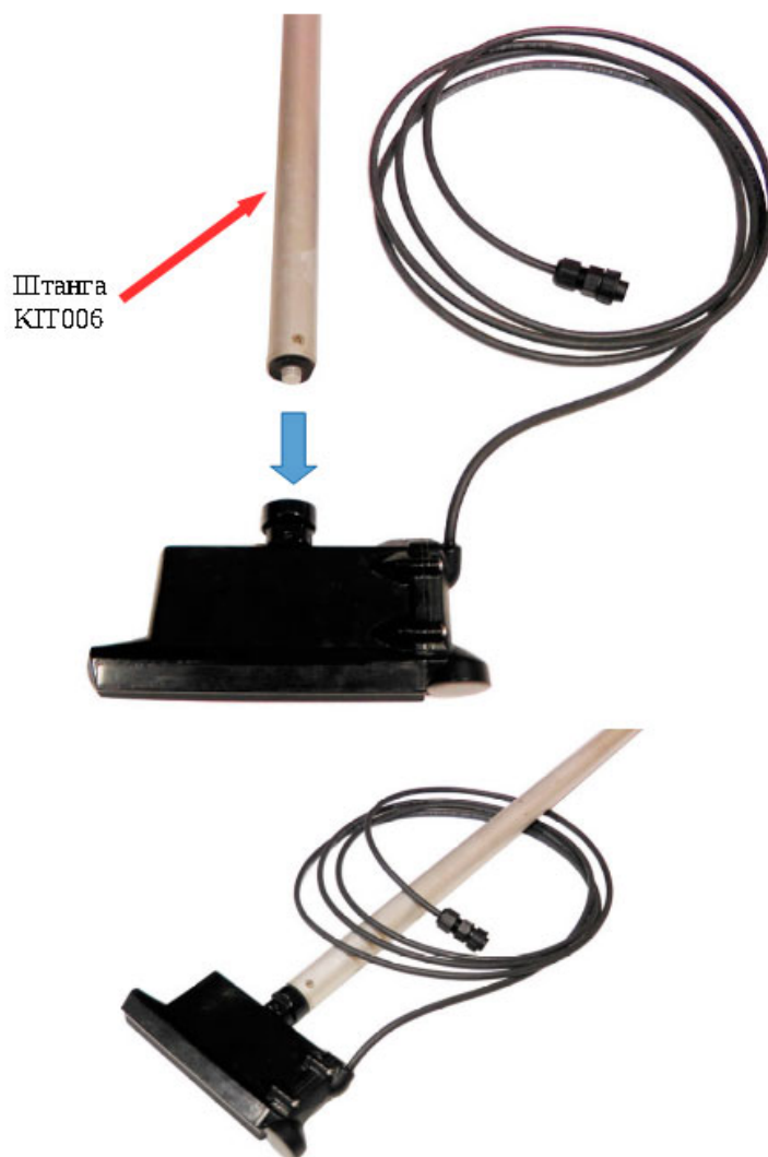
Рисунок К.2. Крепление ГБО к штанге KIT006
