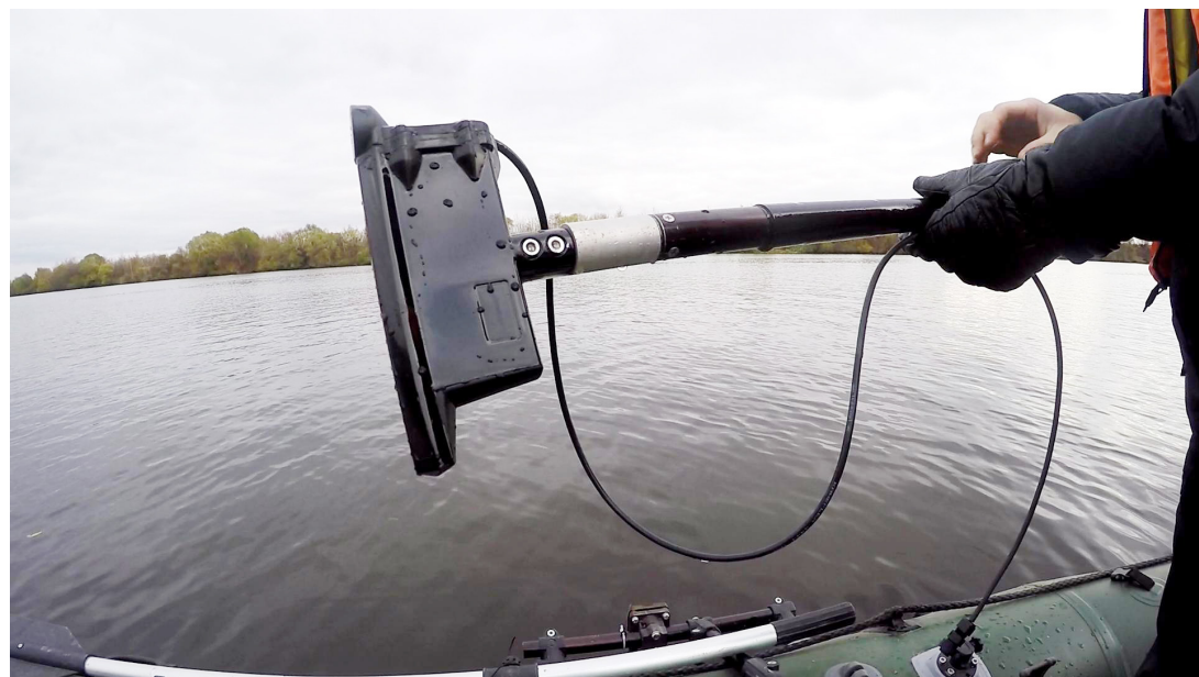
Рисунок К.1. Крепление ГБО на надувную лодку с помощью КИТ006
