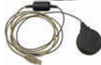
Приемник навигации. Точность 3м.
