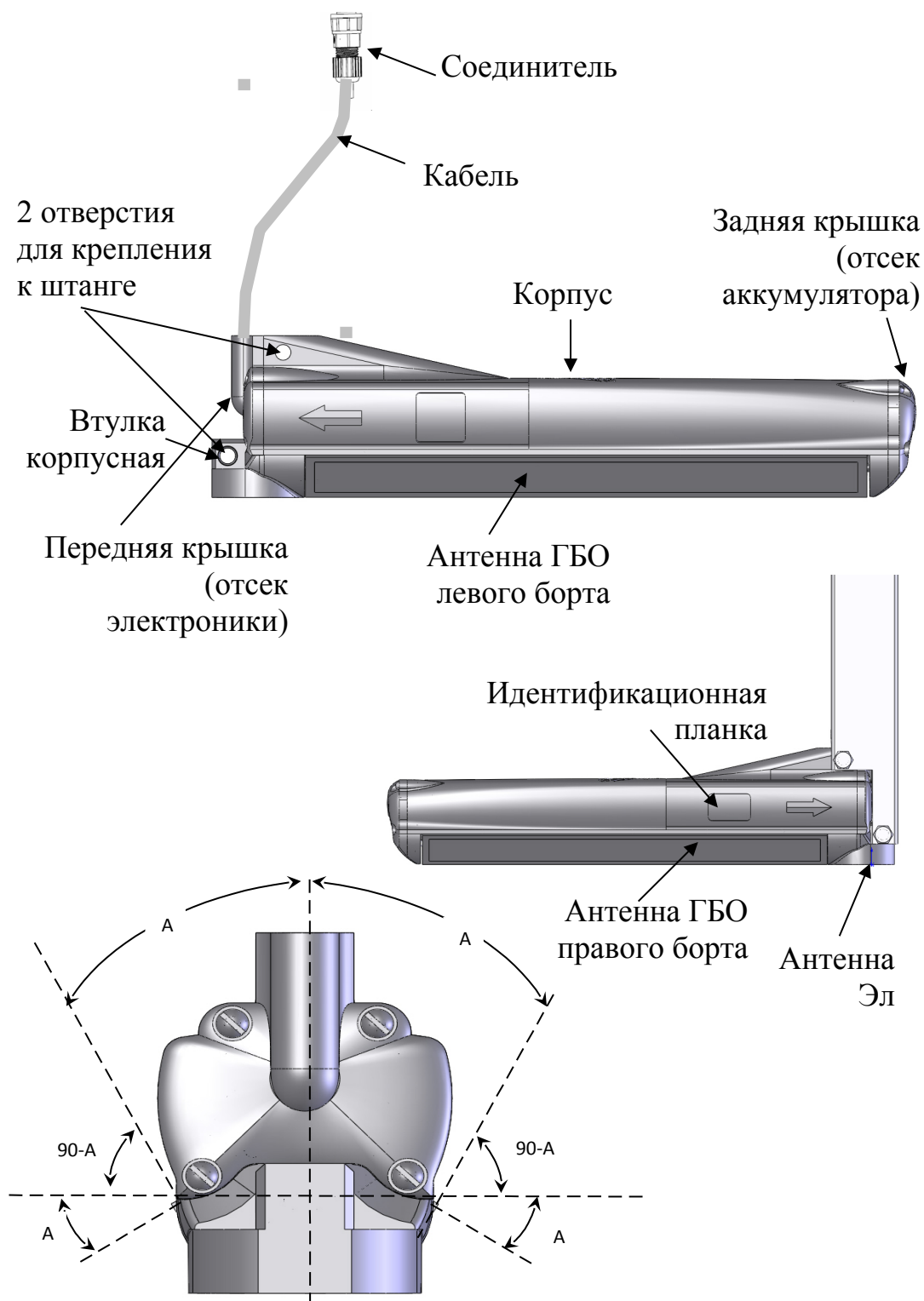
Рисунок 1. Конструкция моноблока
