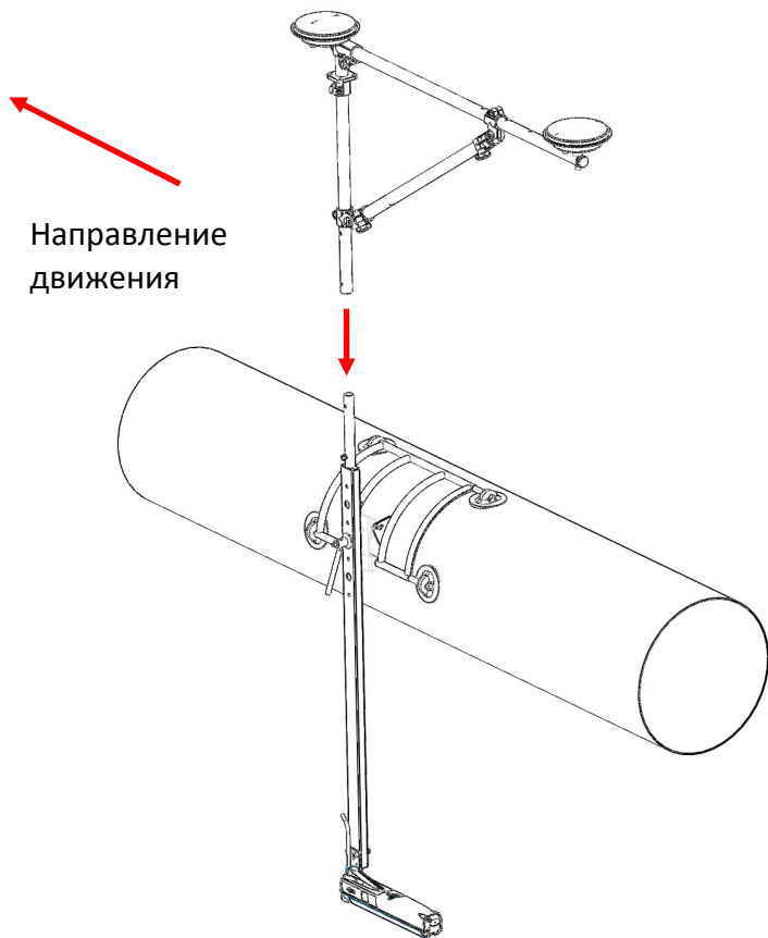
Рисунок 2. Установка на штангу (левый борт)
