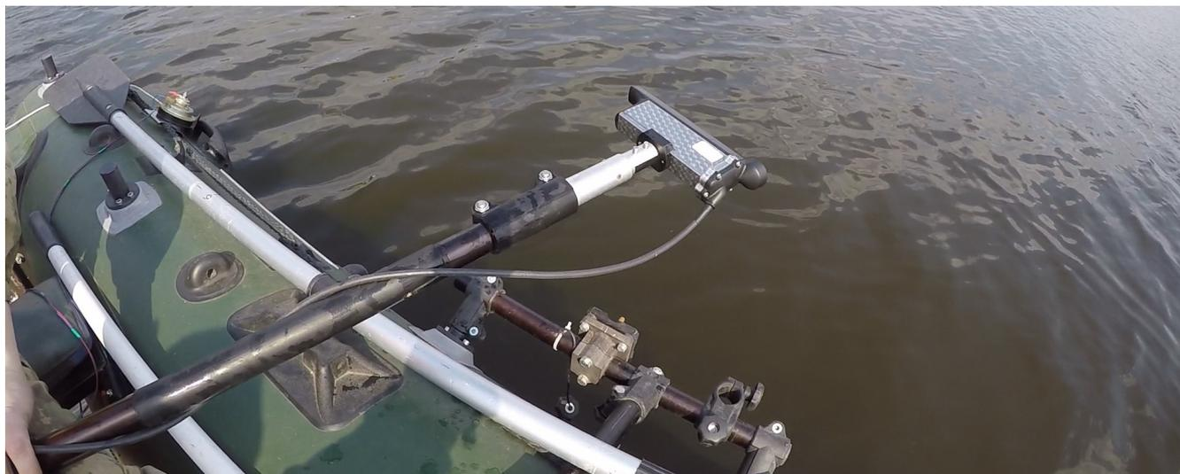
Рисунок 2. Установка H5se12 на лодке с борта с помощью трубчатого крепления KIT006
