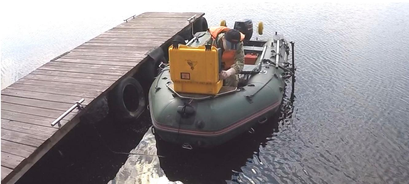
Рисунок 3. Установка H5se12 на лодке с борта с помощью трубчатого крепления KIT006 (рабочее положение)
