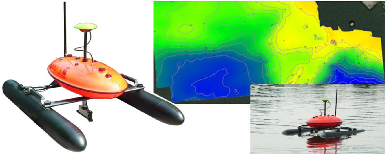
Рисунок 6. Установка H5se12 на соноботе
