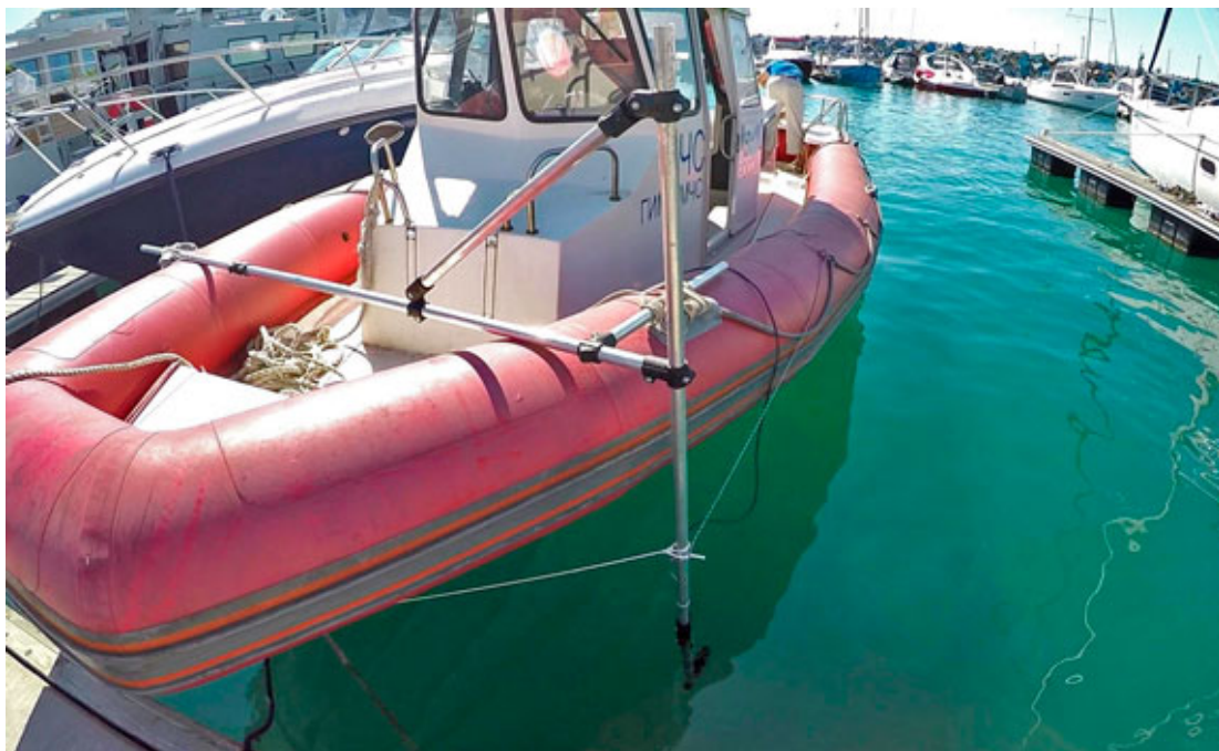
Рисунок 6. Установка H5s7E на катере (походное положение)
