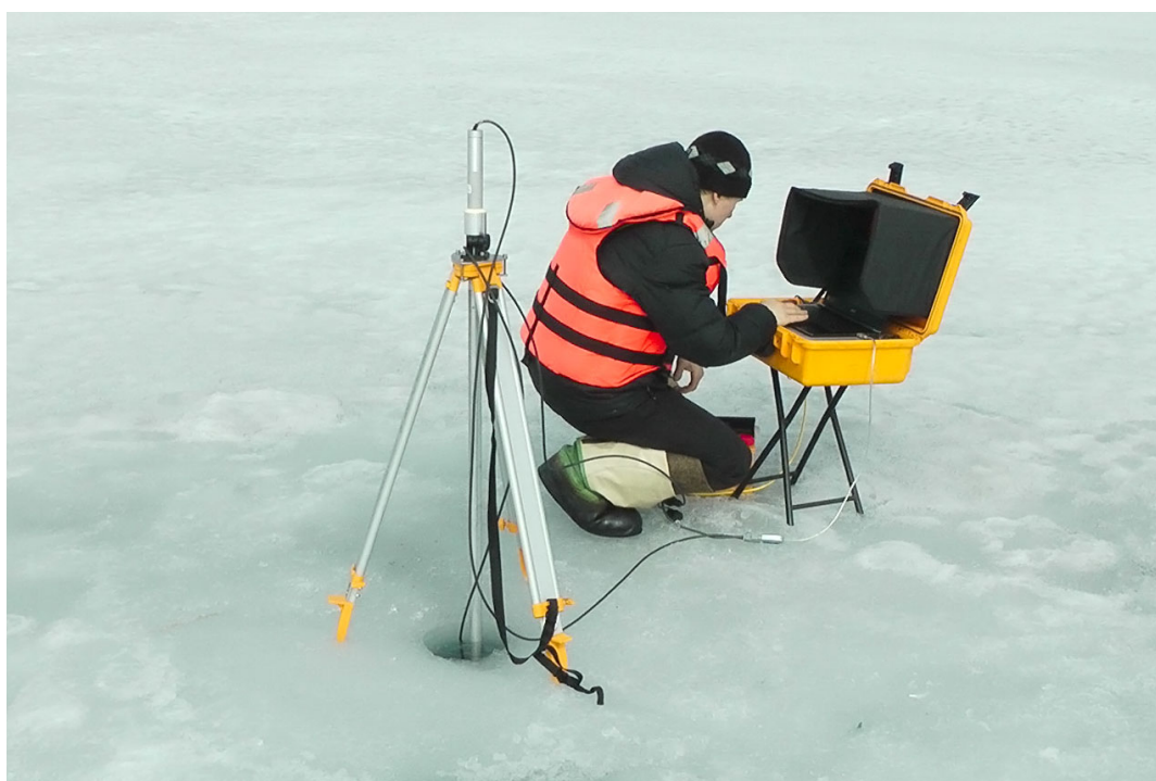
Рисунок 9. Установка ГБО на привод кругового обзора SSU003
