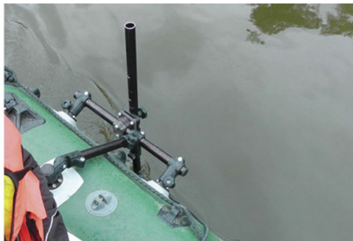
Рисунок 1. Установка Н5s7Е на лодке с борта с помощью трубчатого крепления КИТ006 (рабочее положение)
