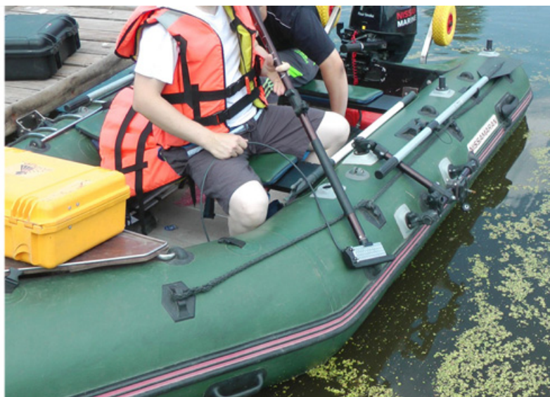
Рисунок 8. H5sf7 и его установка на надувную лодку с помощью KIT006
