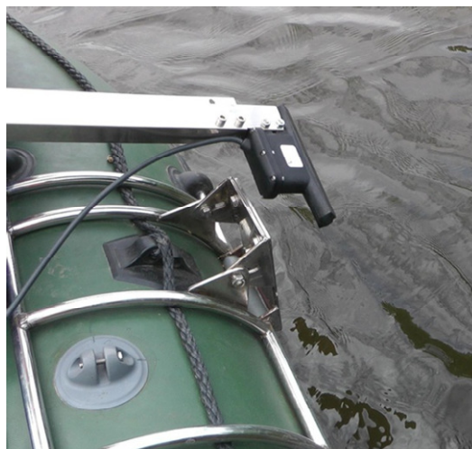
Рисунок 3. Установка Н5s7Е на штанге 50x25мм
