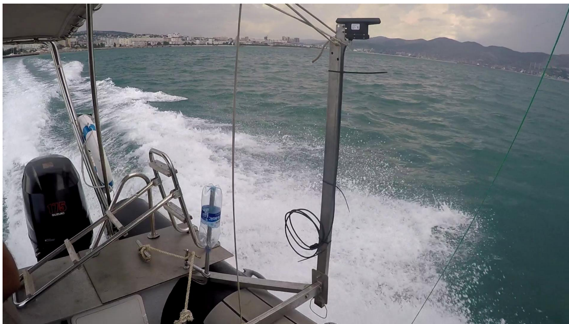
Рисунок 6. Установка H5s7E на катере (походное положение)
