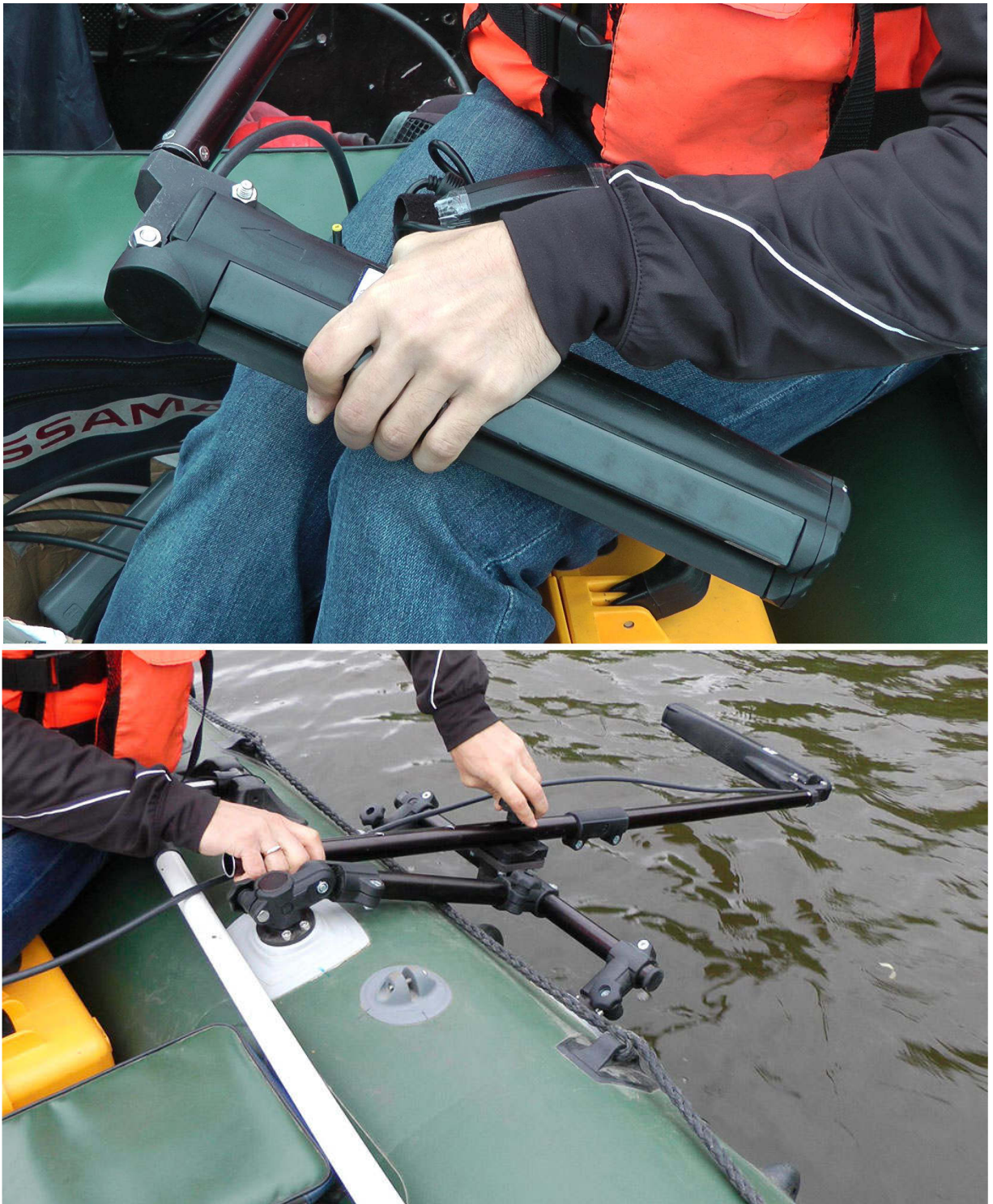
Рисунок 1. Установка Н5se3 на лодке с борта с помощью трубчатого крепления КИТ006
