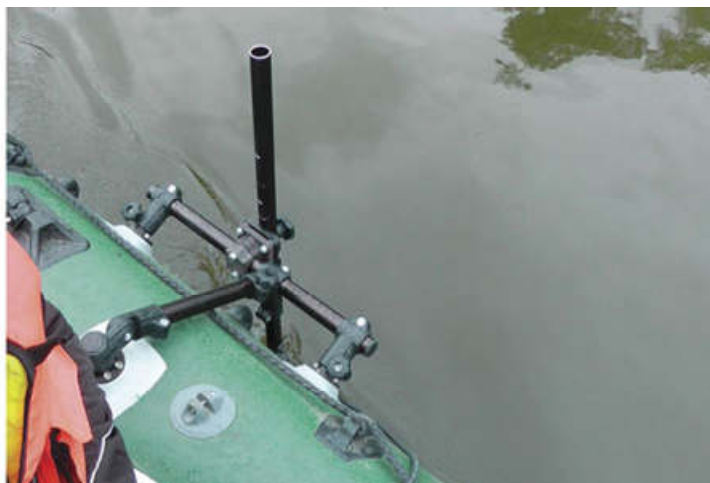
Рисунок 2. Установка Н5se3 на лодке с борта с помощью трубчатого крепления KIT006 (рабочее положение)
