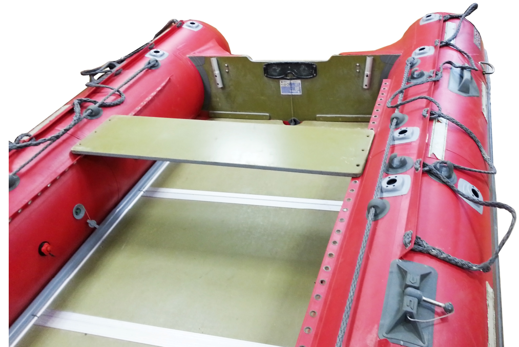
Рисунок 11. Установленные площадки ramпы и лебедки
