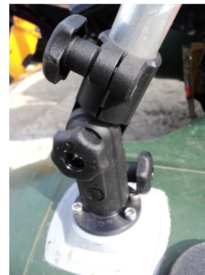
Рисунок 15. Установка шарнирного зажима на опору
