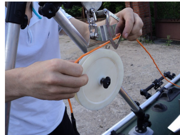
Рисунок 18. Проводка кабель-троса через буксировочный блок
