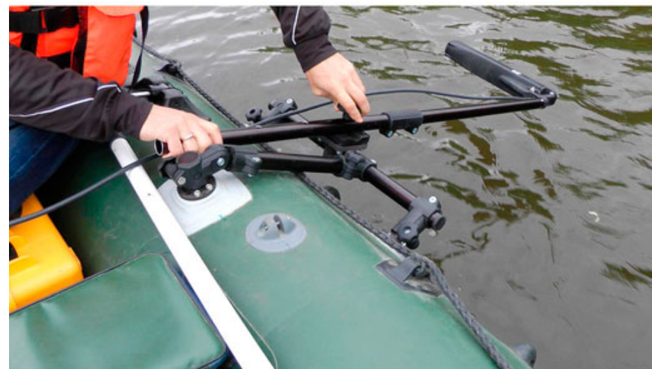
Рисунок 14. Установка штанги с гидролокатором H5se3
