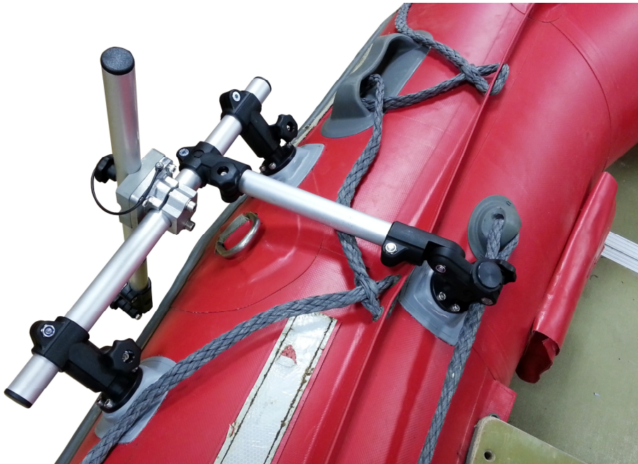
Рисунок 11. Пример установки набора с левого борта на лодке типа Фаворит 470
