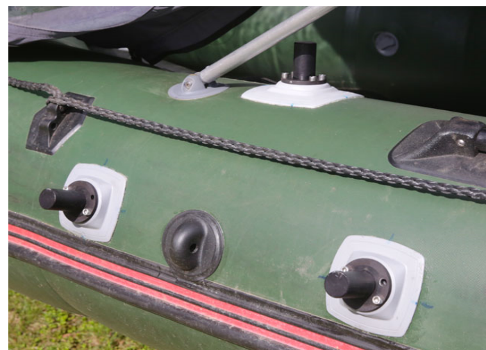
Рисунок 10. Установка адаптеров на площадки
