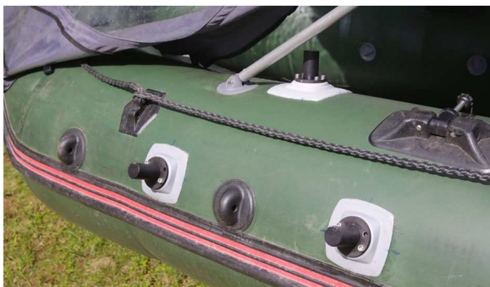
Точки установки крепления на борту лодки
