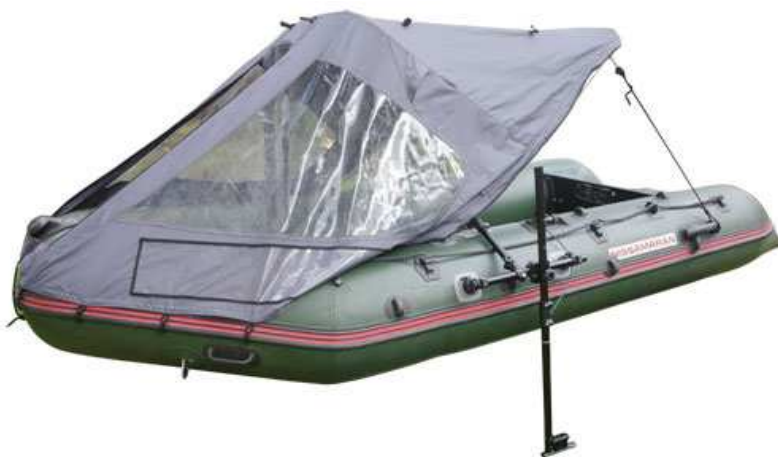
Крепление с гидролокатором H5s7 (рабочее положение)
