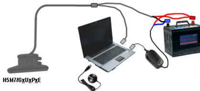
Типовая схема подключений комплекса при питании от одного аккумулятора
